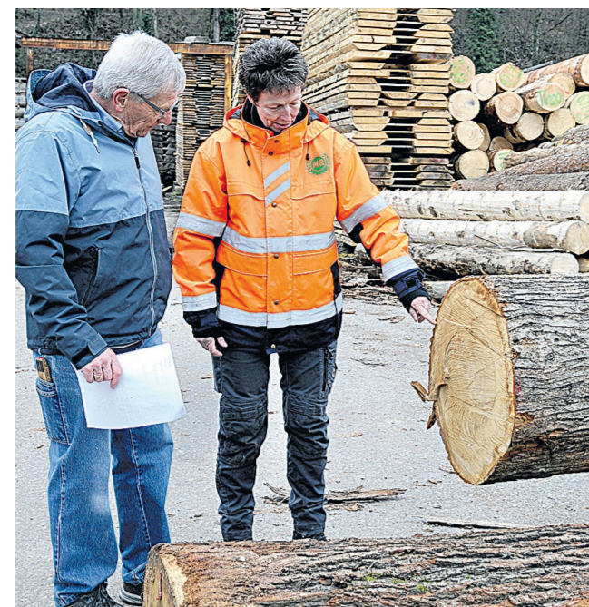
Walter Hess und Elisabeth Schmid messen bei Knecht Holz in Koblenz die Eichen aus und bestimmen, wie sie aufgeschnitten werden.
